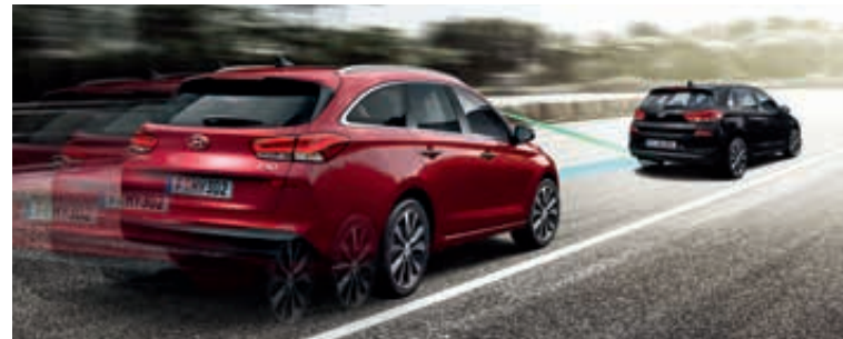
Autonomní nouzové brzdění AEB (Autonomous Emergency Braking) s funkcí detekce chodců používá částečný nebo maximální brzdný výkon, pokud hrozí potenciální kolize.
