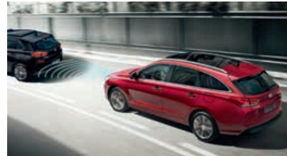
Inteligentní adaptivní tempomat ASCC (Advanced Smart Cruise Control) udržuje nastavenou vzdálenost od vpředu jedoucího vozidla a v případě potřeby automaticky snižuje nebo zvyšuje rychlost jízdy.
